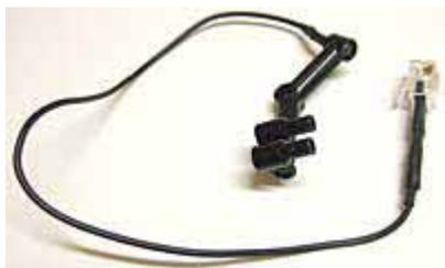
这是已经制作好的一根 LED 灯线。LED 灯放在 LEGO 连接器的孔里面，然后通过连接器固定在 NXT 上。根据你所选择的 LED 灯，或许能恰好放到孔里面，也可能不行。如果太紧的话，你不得不挫一下 LED 灯的两侧或者稍微扩大一下孔...
