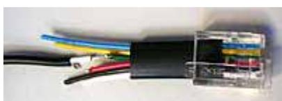
我们从一段短的 NXT 线开始。仅仅使用中间的两根线。其它几根线留的长一些，会起到溢流的作用。为了延长 NXT 导线，选择一根比较柔软的 2 线制线能够连接 LED 灯。我是用了一根废旧的音频线。
