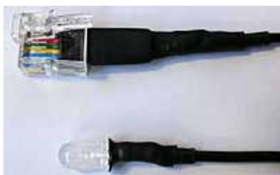
两根完成的线头。热缩管包住了 LED 灯的焊接点。
