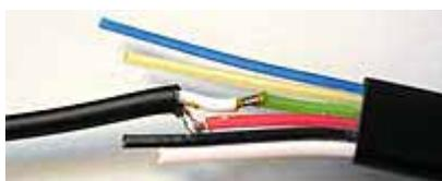
线留的长短尽量不一样在不单独绝缘的情况下避免短路。仅仅需要红色（地线）和绿色（电源线）两根线。
