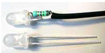
LED 灯焊在线的另一端。LED 短脚那一端通过 150 欧的电阻接地，长脚直接通过 4.3V 直接来供电。同样，这里再次采取了长短不同的方式避免短路。**注意：**在焊接 LED 灯之前不要忘了放热缩管！
