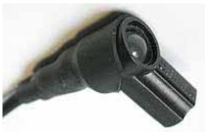
放在孔里面的 LED 灯的特写。一段圆滑的软管包裹在 LED 外，并且连接器能够阻挡光不从后面发出。
