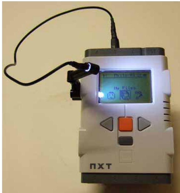
由于 NXT 的屏幕没有背景光导致黑暗的条件下浏览屏幕上的信息非常困难。那么非常简单，可以制作一个小的 LED 灯，放置在屏幕上方来帮助我们解决这个问题。通过任何传感器或者马达端口来对该灯进行供电。
